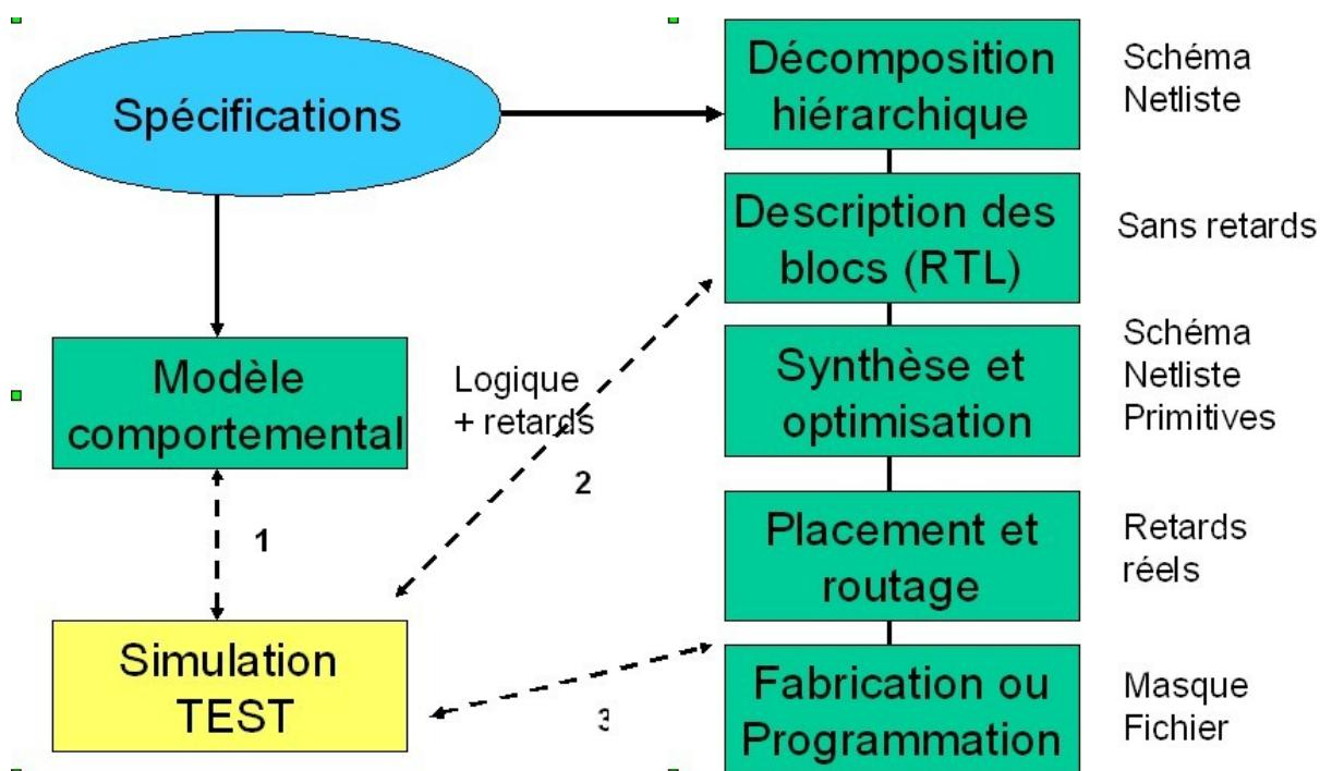
On observe sur cette figure le rôle fédérateur du VHDL car il intervient au moins sur 3 niveaux, celui de la description comportementale traduisant les spécifications, celui du code RTL (Register Transfert Level) et enfin au niveau technologique post-routage censé représenter le circuit « vrai ». Ces trois types de description seront validées par une même famille de fichiers de test eux-même écrits en VHDL.
